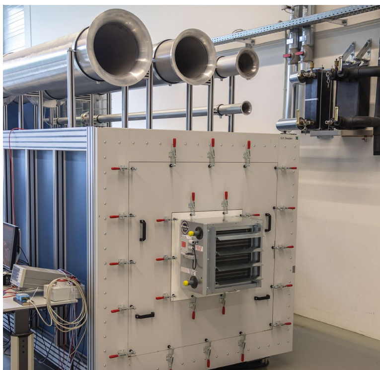
Testopstelling voor luchtprestatiemetingen volgens DIN EN ISO 5801, Kampmann F&E Center
