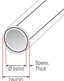
**TUBO FASER FIBER-COND**, tubo pluristrato con strato intermedio caricato con fibre speciali
