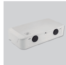
AIRSENS RF SABIK- CO2 NL Luchtkwaliteit-sensor voor vraag-gestuurd ventileren. 230V voeding, draadloze communicatie i.c.m. ontvanger REC.AirSens. Tot 4 sensoren te koppelen op 1 SABIK-unit.
